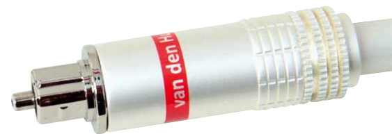
Die Stecker sind aus Metall, beide Enden des Lichtleiters sind mit einer konvexen Linse versehen, das vermindert Streuungen und sorgt für sicheren Kontakt
