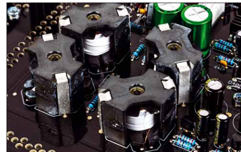
Das Entzerrernetzwerk arbeitet mit extrem eng tolerierten Drosselspulen
