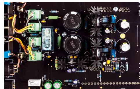
In der Mitte der Platine im Hauptgerät werden die Betriebsspannungen aufbereitet und verteilt
